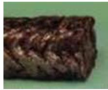
Trenzado de una combinación de grafito expandido y flexible (1100TCP) y de alta resistencia fibras de carbono (90). Las fibras de carbono son trenzadas en las esquinas para proporcionar anti-extrusión y mejor resistencia a la abrasión en aplicaciones difíciles. Se puede dar un rendimiento prácticamente libre de fugas. 1100CR se forma independiente Test de fuego a la API de 589 a 607 API temperaturas y presiones.
