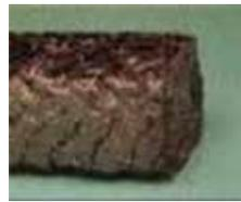
Trenzado de una combinación de grafito expandido y flexible de alambre inconel. 110 que mantiene la estabilidad dimensional a altas temperaturas, ambientes de alta presión, y puede cumplir con las regulaciones de emisiones de COV más de control. 1100 que se forma independiente Test de fuego a la API de 589 a 607 API temperaturas y presiones
