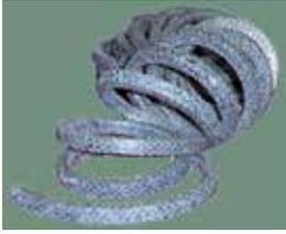
Trenzado de grafito puro expandido. Es resistente, auto-lubricante y lubricado con teflón, químicamente inerte y conductora térmicamente. 1100PTF puede utilizarse en ambas bombas y válvulas en una amplia gama de condiciones de servicio.
